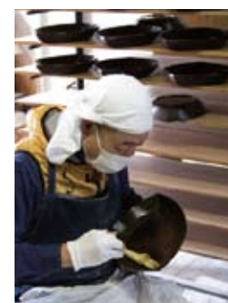
▶ブナの木のスライス ▶テーブル状にカット ▶コイル状に巻く ▶巻き上げられた型 ▶成型し、接着 ▶乾燥
