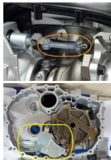
上/確かなプレス加工技術で複雑な形状と高レベルな耐久力を両立させた、ターボチャージャー向けプレート 下/トランスミッションの油量を制御するパッフルプレート
