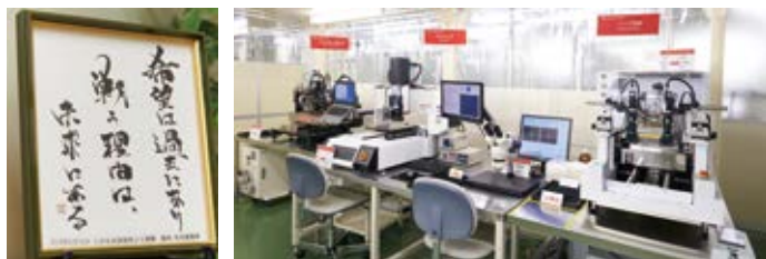
小説家バルザックと出光 佐三の言葉を組み合わせ、同社が開発した半導体実装装置「デスクトップファクトリー」は100ボルトの電源で駆動することができる せたスローガン
